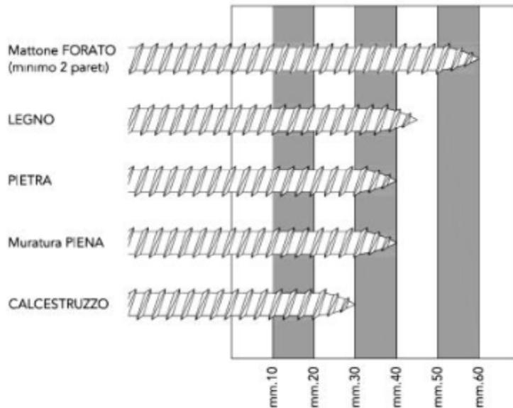
La lunghezza totale della vite, sarà individuata aggiungendo lo spessore del control telaio e dello spazio tra control telaio e muro.
